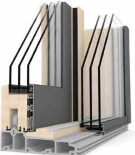
**Toplinska izolacija** do  $U_w = 0,73 \text{ W}/(\text{m}^2\text{K})$
