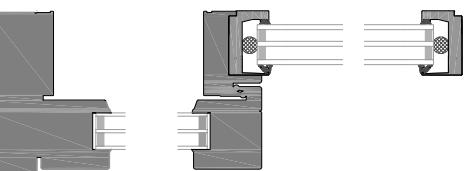
Podizno-klizna vrata od drva od aluminija sa ostakljenjem bez vidljivih okvira.
